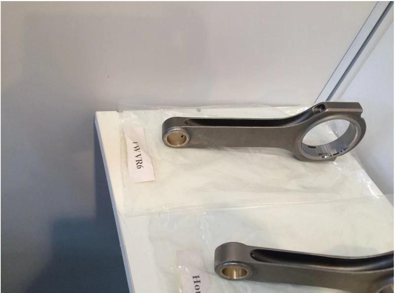
Diese geschmiedeten H-Beam-Stangen sind mit gebohrtem Gewehr erhältlich, das die Lebensdauer der Gelenkbolzen durch zusätzliche Schmierung erhöhen kann [Kontakt](#) uns für Ihre Forderungen
