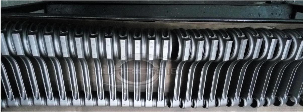
Hurrikan H-Träger Stahlverbindungsstangen 164mm (6 Stück) werden passt foder VW Golf / Jetta - 2,8 2,9 3,2 L R32 VR6 Motoren. Mit Ausnahme des H-Beam-Designs bieten wir für dieses Modell auch I-Beam- und X-Beam-Design an.
