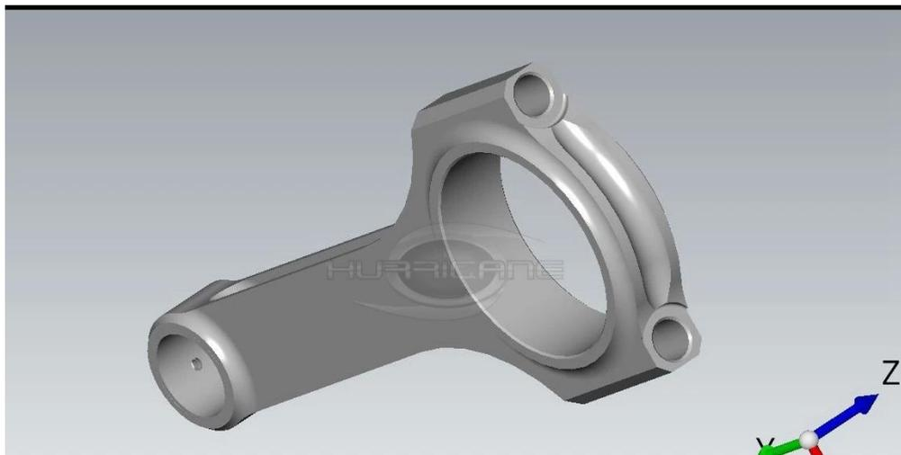
На стержень использовал конструкцию H-Beam, которая увеличивает прочность скручивания и надежность стержня, также может сэкономить немного веса и сделать стержни более легкими. Более того, на одну верхнюю часть маленьких концов на стержень с небольшим маслом отверстием, чтобы масло могло капать во время цикла сжатия поршня, затем обеспечить дополнительную смазку и охлаждение до втулки в небольшом конце, что полезно для защиты стержней сильнее и долговечно.
