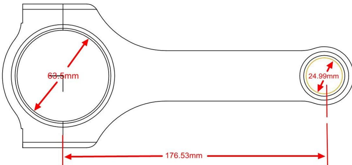
Эти удочки для 6.4L Chrysler. Шатуны урагана отточены, предварительно очищены и сбалансированы по весу (+/- 1 г каждого комплекта), что означает меньше времени в механическом цехе, и вы можете использовать / продавать их, когда стержни в руке Для более шатунов Chrysler, пожалуйста, [кликните сюда](#) Если у вас есть какие-либо вопросы или вопросы, пожалуйста, [заполните эту форму](#) и мы свяжемся с вами в ближайшее время.
