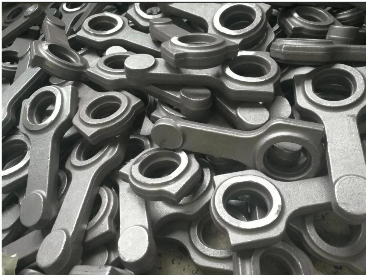
Все поверхности подвергаются дробеструйной обработке и микрополировке перед окончательной обработкой. Это снимет стресс и улучшит усталость жизни.
