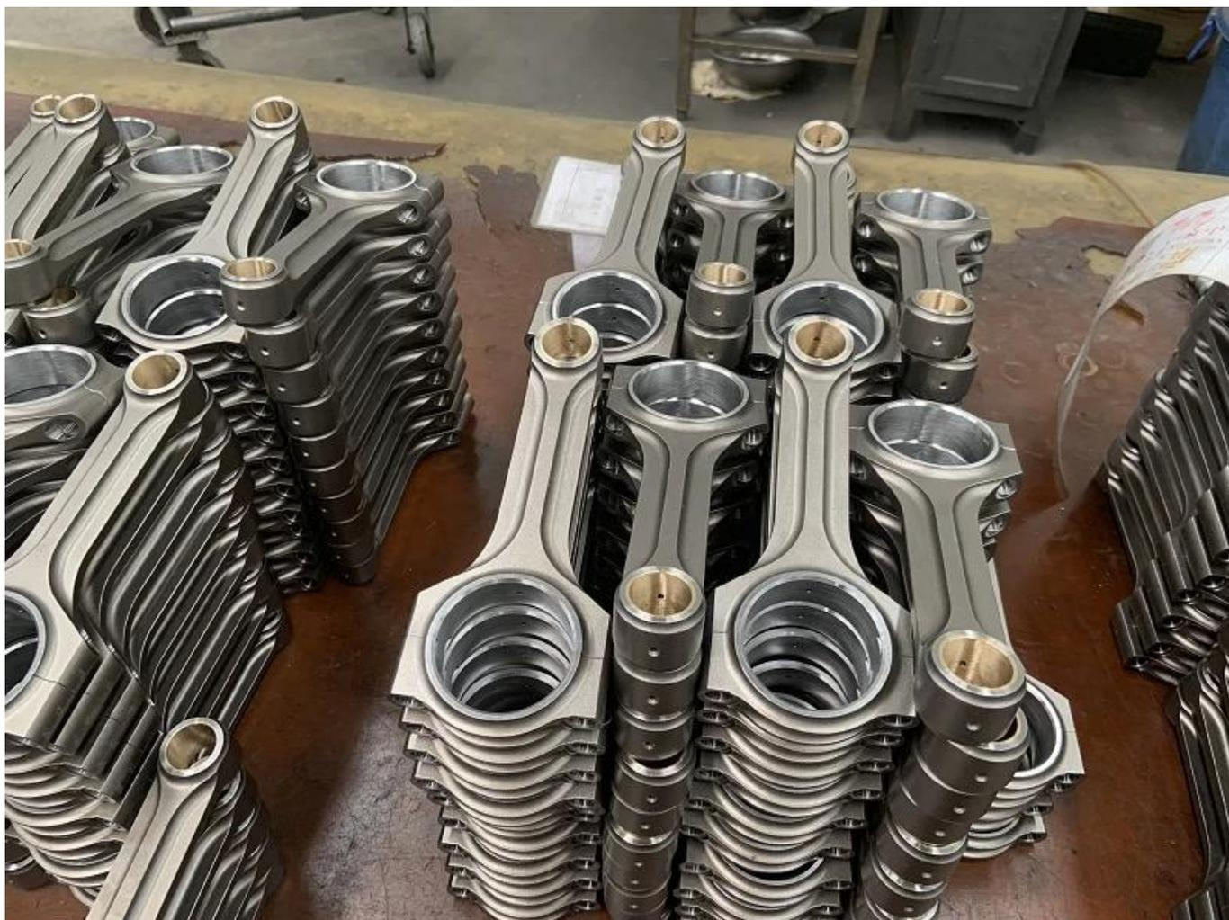
Кованые соединительные стержни 144x22 VW & Audi RS3 готовы к упаковке. Приложение для бурения винтовки доступно во всех ураганах 4340 стальных соединительных стержней, и они продаются отдельно, пожалуйста, свяжитесь с нами для получения дополнительной информации, если вы заинтересованы. И Audi RS3 X-Beam винтовка, просверленные соединительные стержни оценивают вес всего 545 грамм за штуку.
