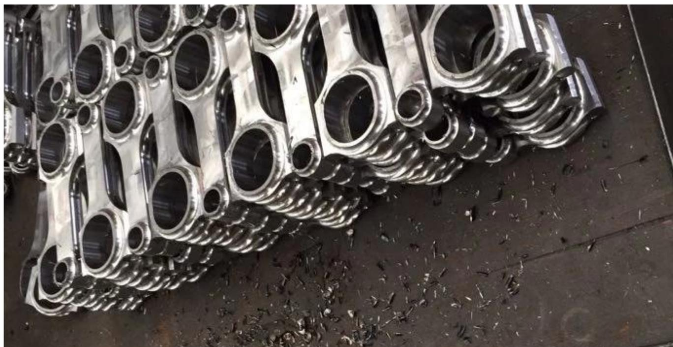
4шт. Соединительные стержни для Toyota Corolla Vios Belta Yaris Echo 1NZFE Двигатель 1NZ-FE обрабатываются с ЧПУ. Мы выполняем строгую процедуру для каждого прогресса, чтобы обеспечить высокий уровень качества. Чтобы проверить больше ураганного завода, сделанный кованный стальной шатун 4340 для toyota, пожалуйста, нажмите [каталог тросов Toyota](#) для получения более подробной информации.
