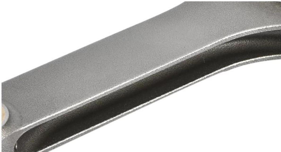
2. Изготовленные на заказ шатуны. Материал: ковкая сталь 4340 / 40CrNiMoA / EN24. Термическая обработка: HRC34-38 с температурой: 860 °C ~ 880 °C
