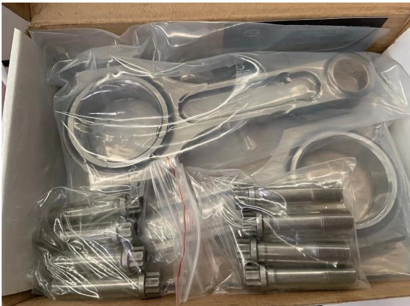
Кованный стальной шатун 4340 для Honda Prelude H23 H23A оснащен [Замена болтов Hurricane 3/8](#).
