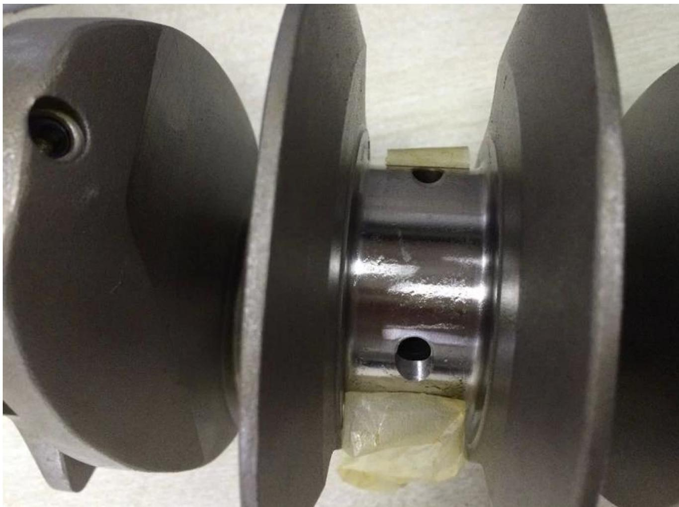
Журнал требует высокой точности менее 0,01 мм. Процесс чистовой шлифовкой, азотированием и полировкой.
