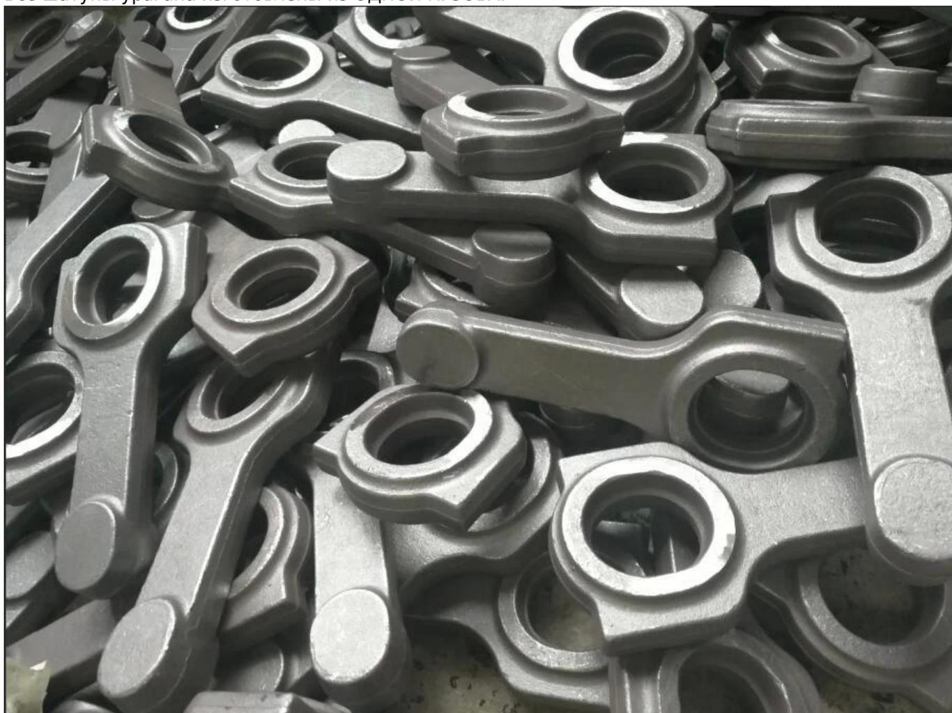
Процессковки вынуждает зерно принимать форму шатуна, что обеспечивает превосходную
