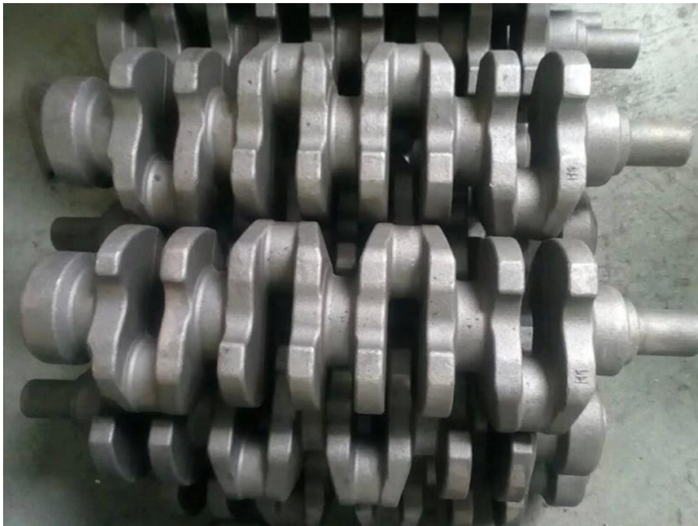
Реконструированный коленчатый вал для поковок Ford 302: многоцелевой штамп подделан от 4340 Chromoly (один из самых сильных материалов, доступных для коленчатых валов)
