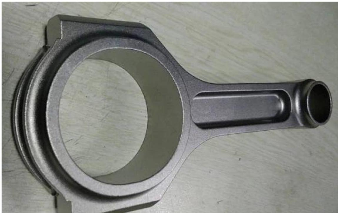
Примечание: Заточка, полировка и дробеструйная обработка - все это ключевые операции при изготовлении шатуна для соревнований. Вы можете [проверить Что такое дробеструйная обработка?](#) страница чтобы получить больше информации.
