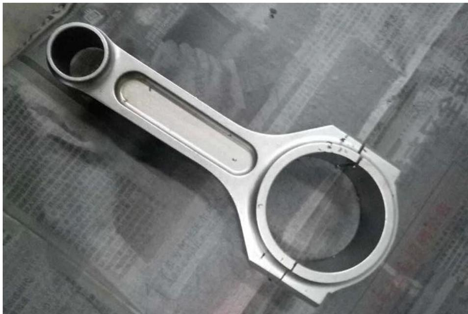
**Примечание:** это этап отделения балки от ее крышки. Чтобы узнать больше о прогрессе, пожалуйста, проверьте: [Шатуны Hurricane High Performance - Процесс обработки стержней](#)
