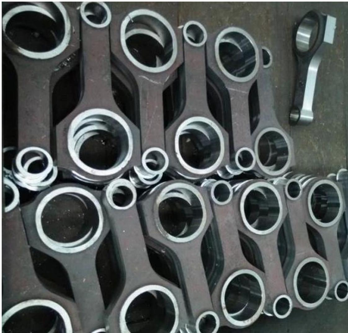
**Примечание: это прогресс дрель Шатуны из ковальной стали для двигателей Buick отверстие для больших и малых концов, которое действует как надежный локатор во всем процессе.**
