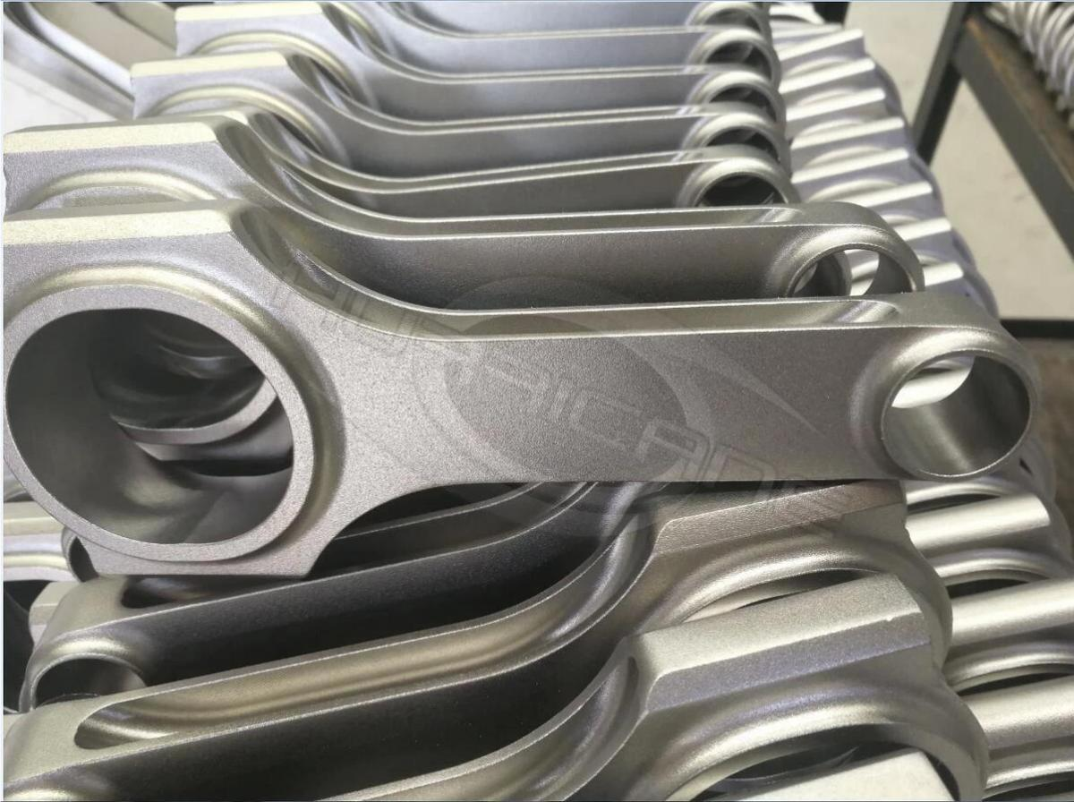
**Готовая картина шатунов** : На большой конец и на маленький конец оттачивается машина SUNNEN. Высокопрочные дюбельные втулки, установленные в крышке стержня, соединяют балку стержня и крышку.
