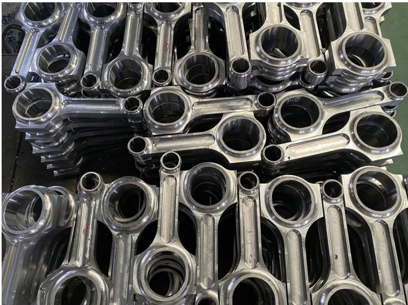
Примечание: GM Chevy V8 V8 кованая 4340 стальных шатунов производственная фотография.
