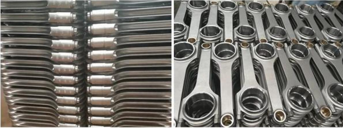
Они поставляются в стандартной комплектации с номиналом 190 000 фунтов на кв. **ARP 8740** и 230 000 фунтов на квадратный дюйм оценили **ARP 2000** болты стержня, или 265 000 фунтов на квадратный дюйм оценили **ARP L-19** болты как апгрейды. Инструкции и смазка стержневых болтов прилагаются.
