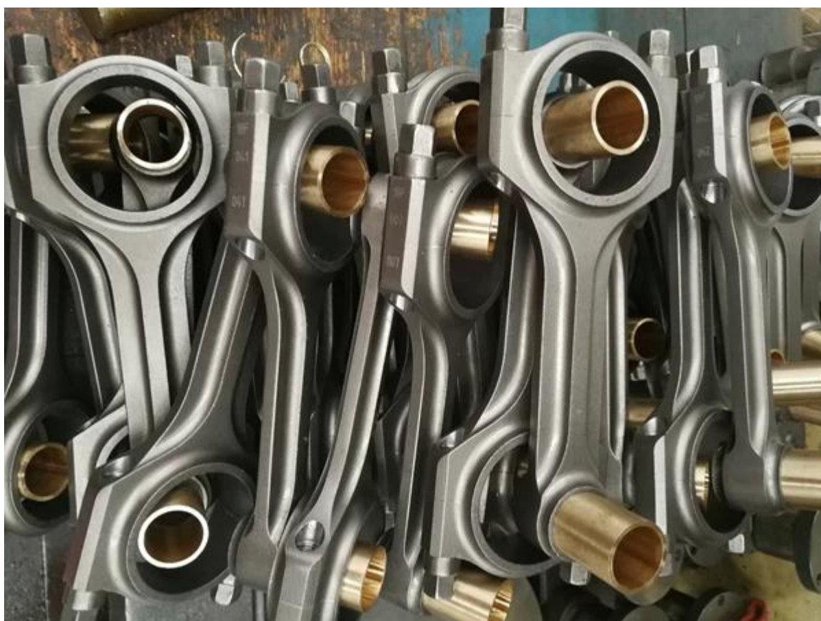
Втулки из силиконовой бронзы вставлены для плавающего поршневого пальца.
