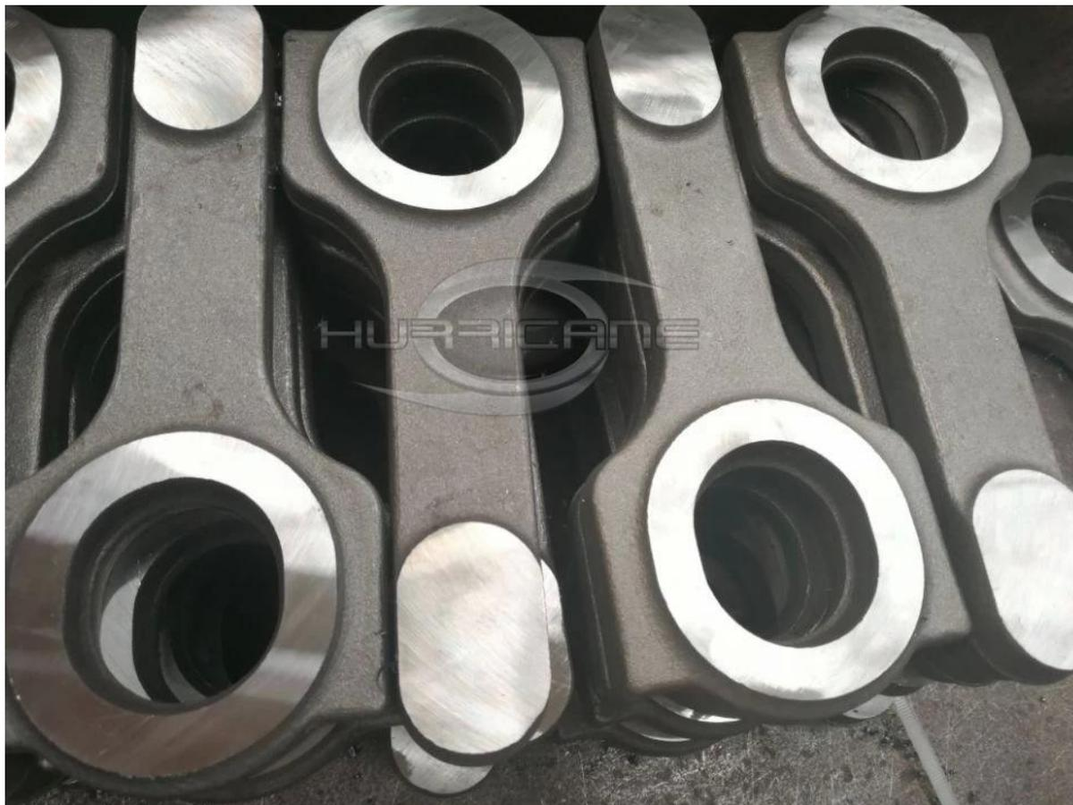
Они подвергаются термообработке до HRC 34-38, затем **полированный и дробеструйный** обеспечить большую усталостную прочность. Все эти малые концы стержней имеют втулку для полностью плавающего штифта, хорошо упакованы в хорошо сбалансированные комплекты +/- 1 грамм и поставляются с болтами 7/16 "ARP 2000.
