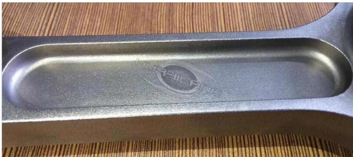
В-третьих, на заводе по производству ураганов каждая отполированная и обработанная дробью штанга подверглась дробеструйной обработке для снятия напряжений при высокой усталостной прочности. С одной стороны, это делает стержни двутавровой балки более надежными в гоночной индустрии; С другой стороны, это помогает сделать поверхность стержней более яркой, гладкой и красивой.
