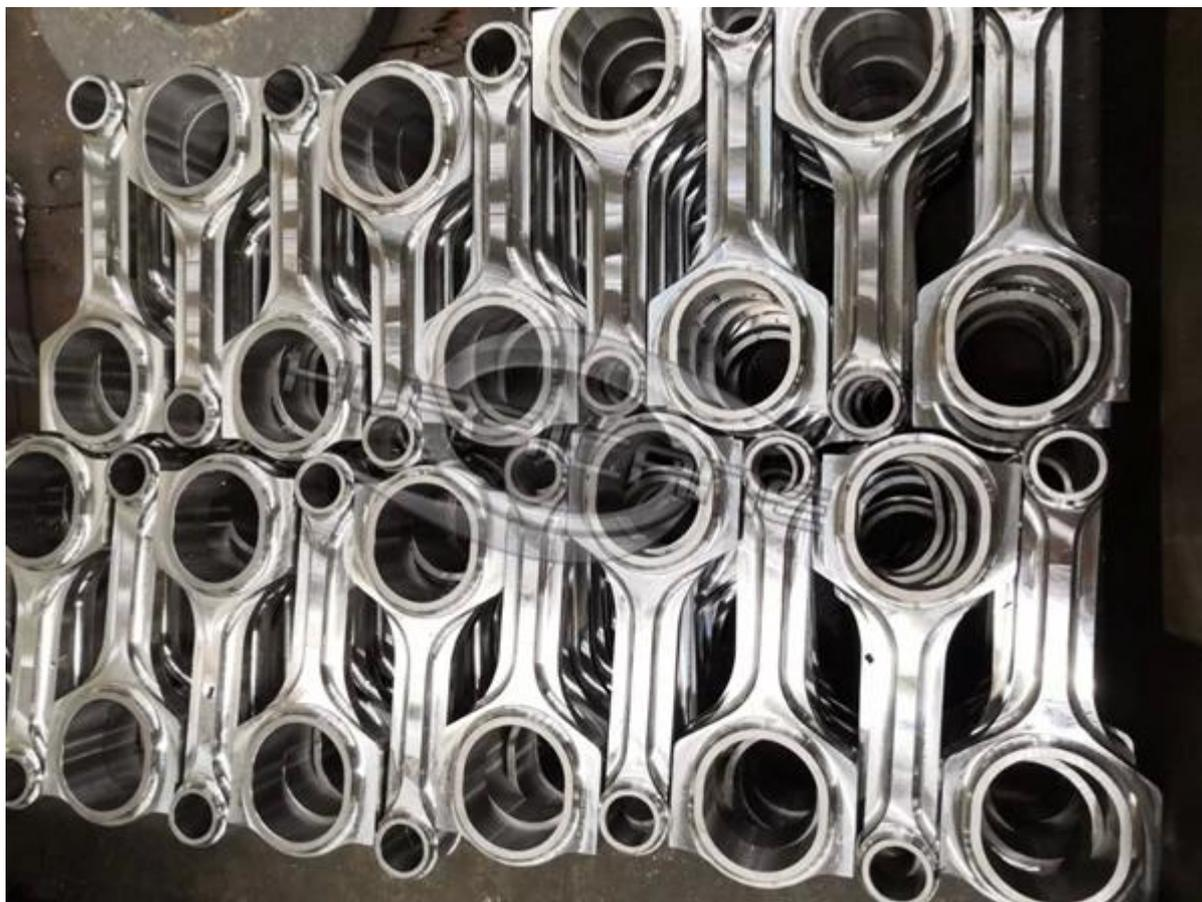
**Duramax Diesel 6.420 "X-Beam Готовый соединительный стержень**
