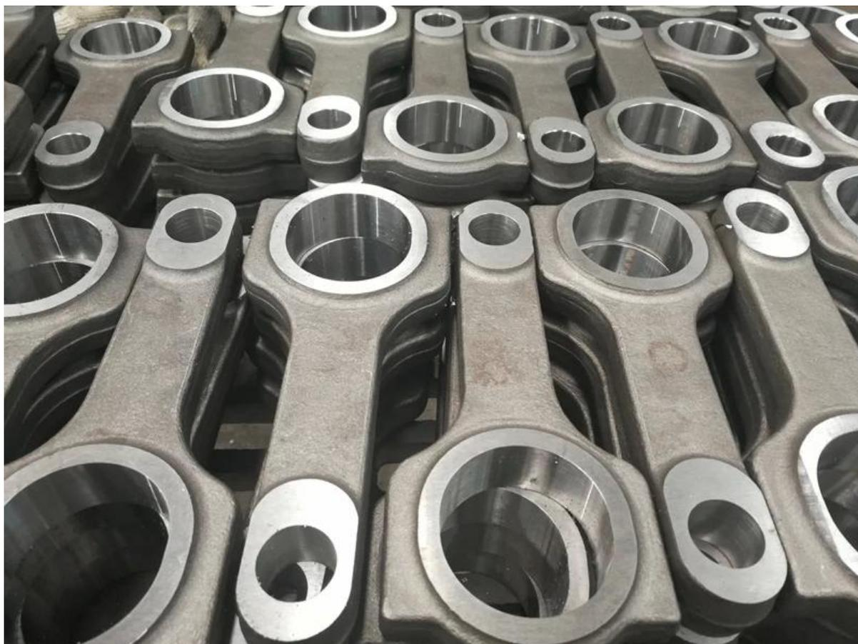
Примечание: просверлите отверстие большого конца и отверстие малого конца
