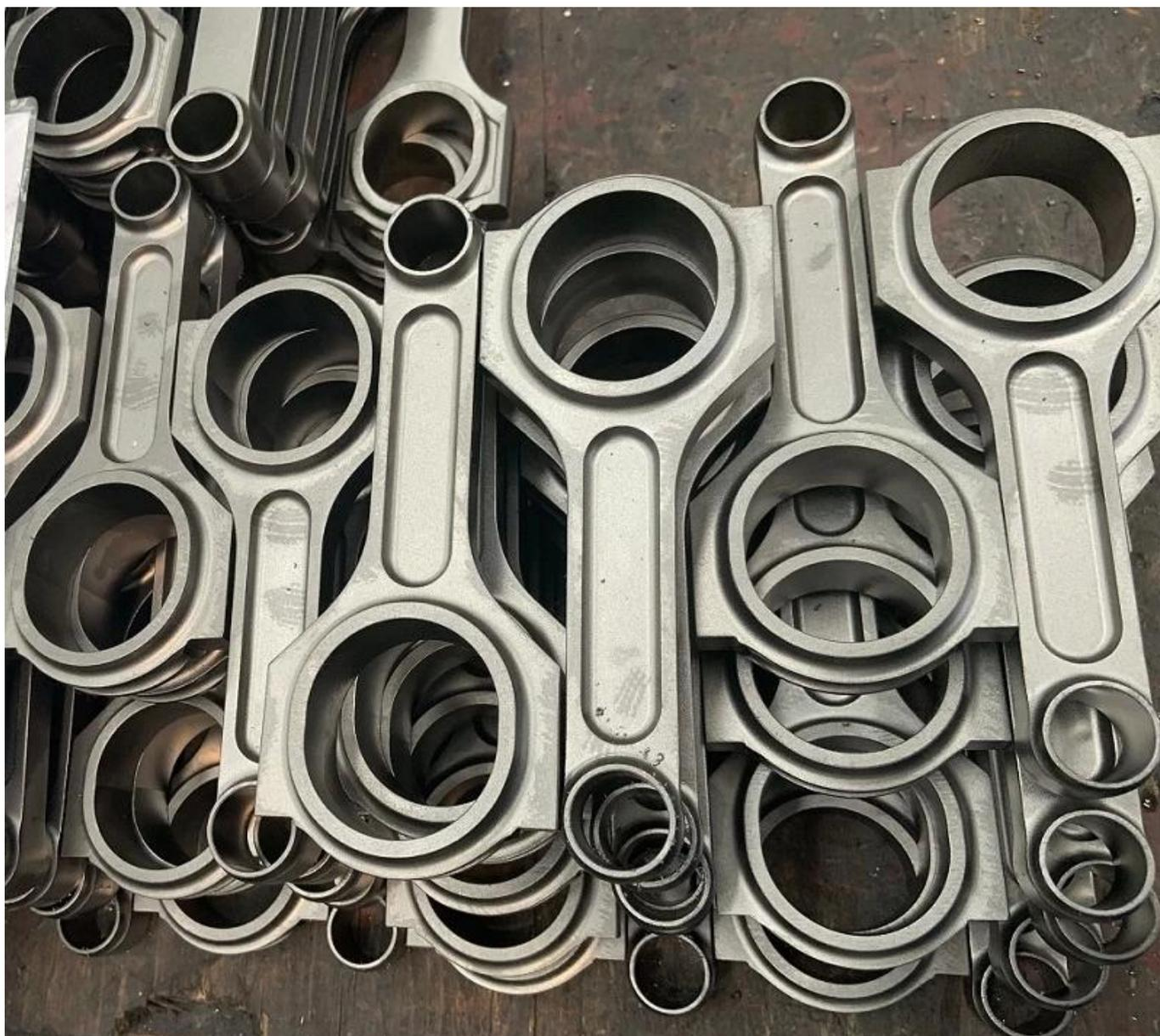
Примечание: Шатуны BMW E46 M3 S54 139 мм из балки с балкой I готовы к дробеструйной обработке. Вы можете проверить более подробную информацию об этом прогрессе на странице новостей: [Шатуны Shot Peening и Mirco-Polishing, Специальный внешний вид A-level](#)
