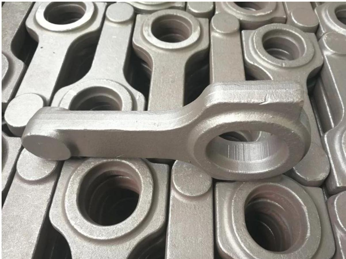
**2. 100% ЧПУ Махин, полированная и обработанная дробью обработка.** Статья, которую вы могли бы изучить "[Шатуны Hurricane High Performance - Процесс обработки шатунов](#)".
