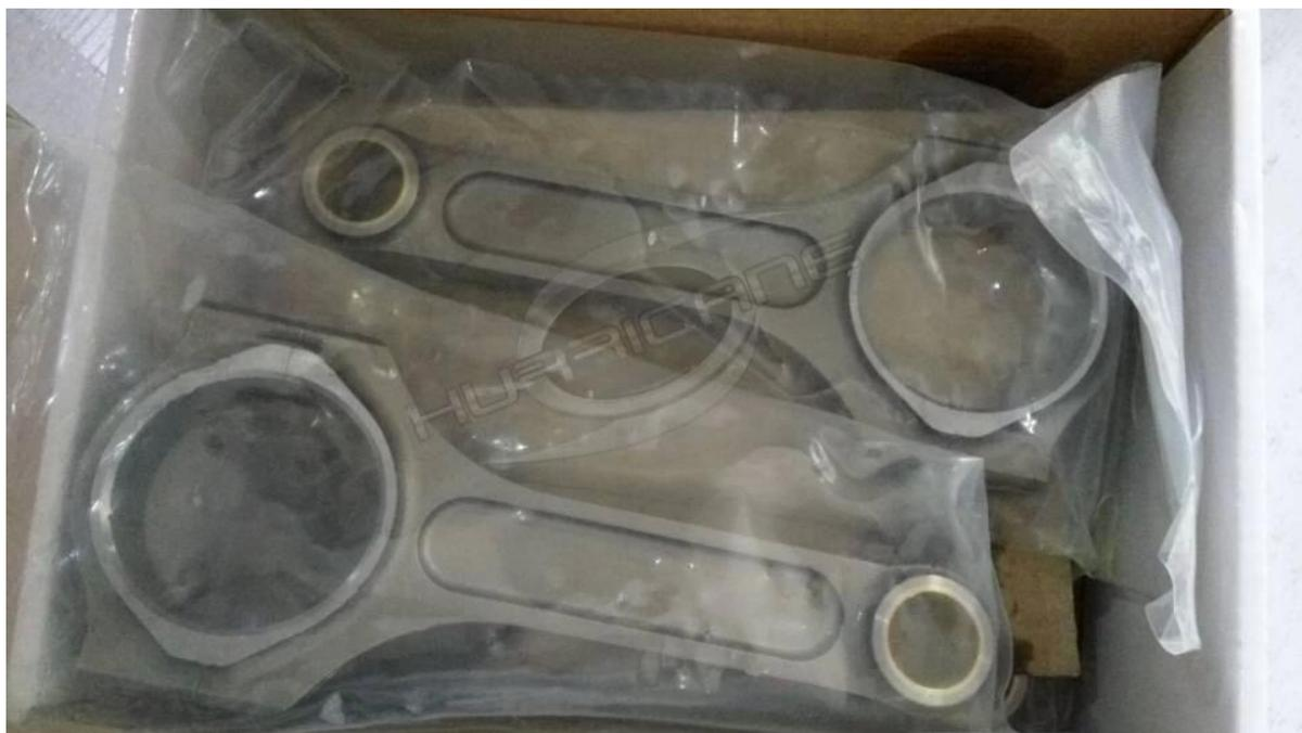
Эти кованые стержни в стиле I-Beam доступны в исполнении с винтовыми отверстиями, которые могут увеличить долговечность штифта запястья, обеспечивая дополнительную смазку. Если вам нравится эта опция для этого стержня, пожалуйста, не стесняйтесь [контакт](#) нам по вашим требованиям.
