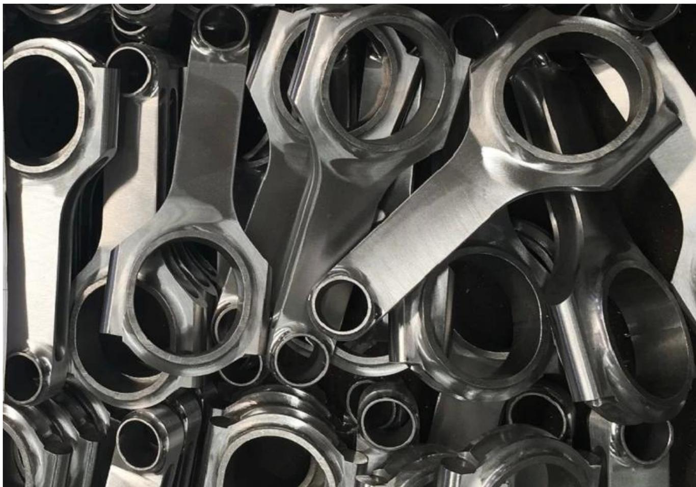
Примечание: заусенцев, полировка, (удалить заусенцев и сделать поверхность гладкой) и выстрел взрывных (малый шар ударил поверхности и сделать их на поверхности, увеличение стержней прочноть с малым мячом) все важнейшие операции в создании конкуренции шатун. Более подробную информацию вы можете узнать по адресу: [Ураган высокая производительность Соединительные стержни-процесс обработки стержней](#) Или проверьте наш опреатионс на YouTube viedo: [Как это сделано: Соединительная штанга](#)
