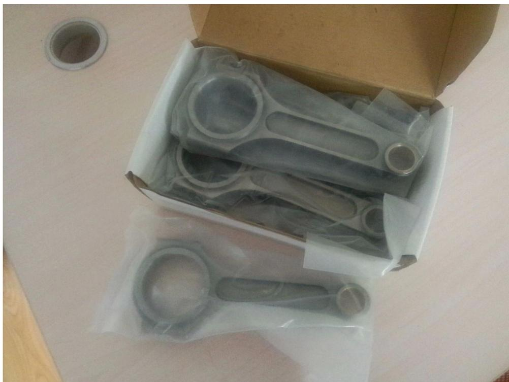
3. Односнабжение имеет нефтяное отверстие в верхней части **маленькие концы** Так что масло будет капать во время цикла сжатия поршня, будет предусмотрена дополнительная смазка и охлаждение.
