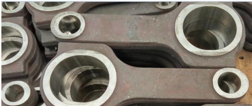
2. Манометр образуется как **Я-лучевая форма** Чтобы обеспечить лучшую комбинацию легкого веса и прочности, каждая камера стержня обрабатывается до HRC 34-38, а затем выстрел на снял для более высокой прочности усталости, укачена на 8 шт. / Набор, оптимальная балансировка для веса сопоставлена  $\pm 1$ грам за набора.
