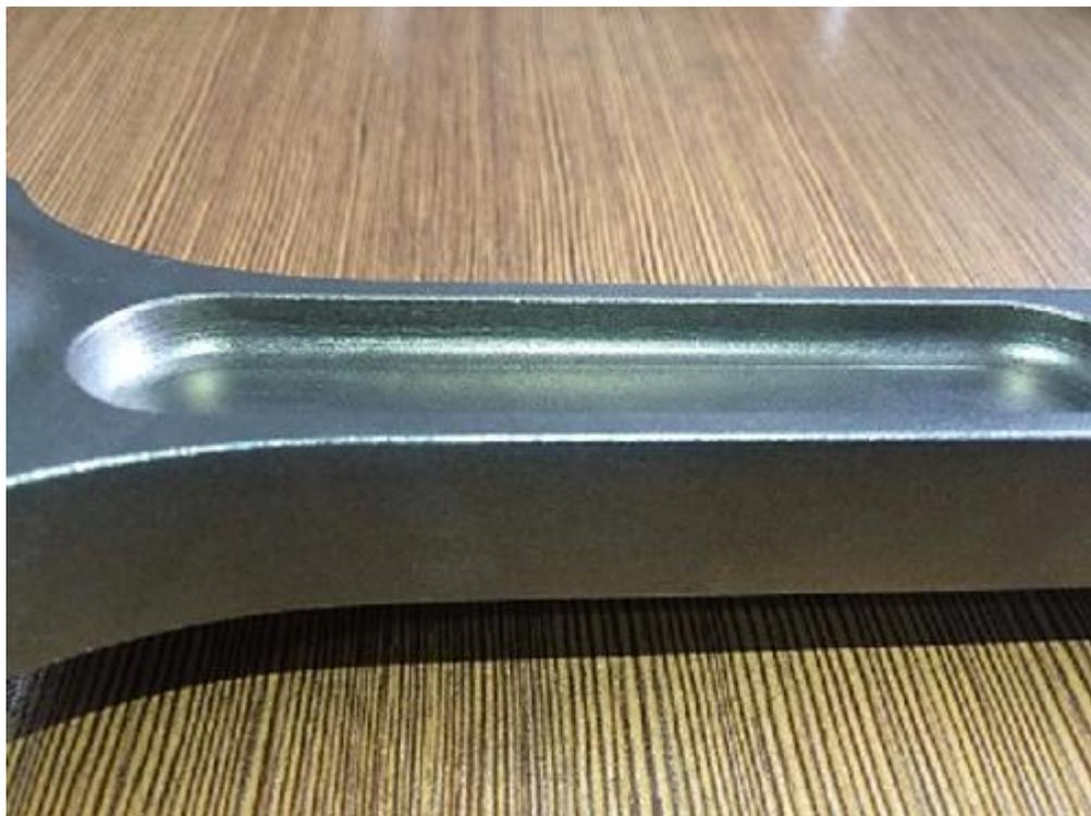
**Примечание: другие 4340 я пучка стержней, След инструмента CNC очень ясный.**
