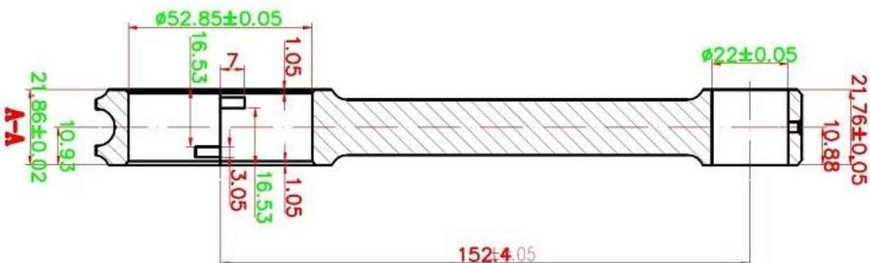
Шасси Nissan Performance 6.000 "152.4 мм соответствуют всем моделям Nissan / Holden RB30. Никакой обработки не требуется. Они подходят для двигателей RB30ET (SOHC), RB30DET (DOHC) и RB30. Каждый стержень имеет бронзовую втулку для полного плавания Применение Концевые масляные отверстия обеспечивают дополнительную смазку и охлаждение. Конструкция балки H
