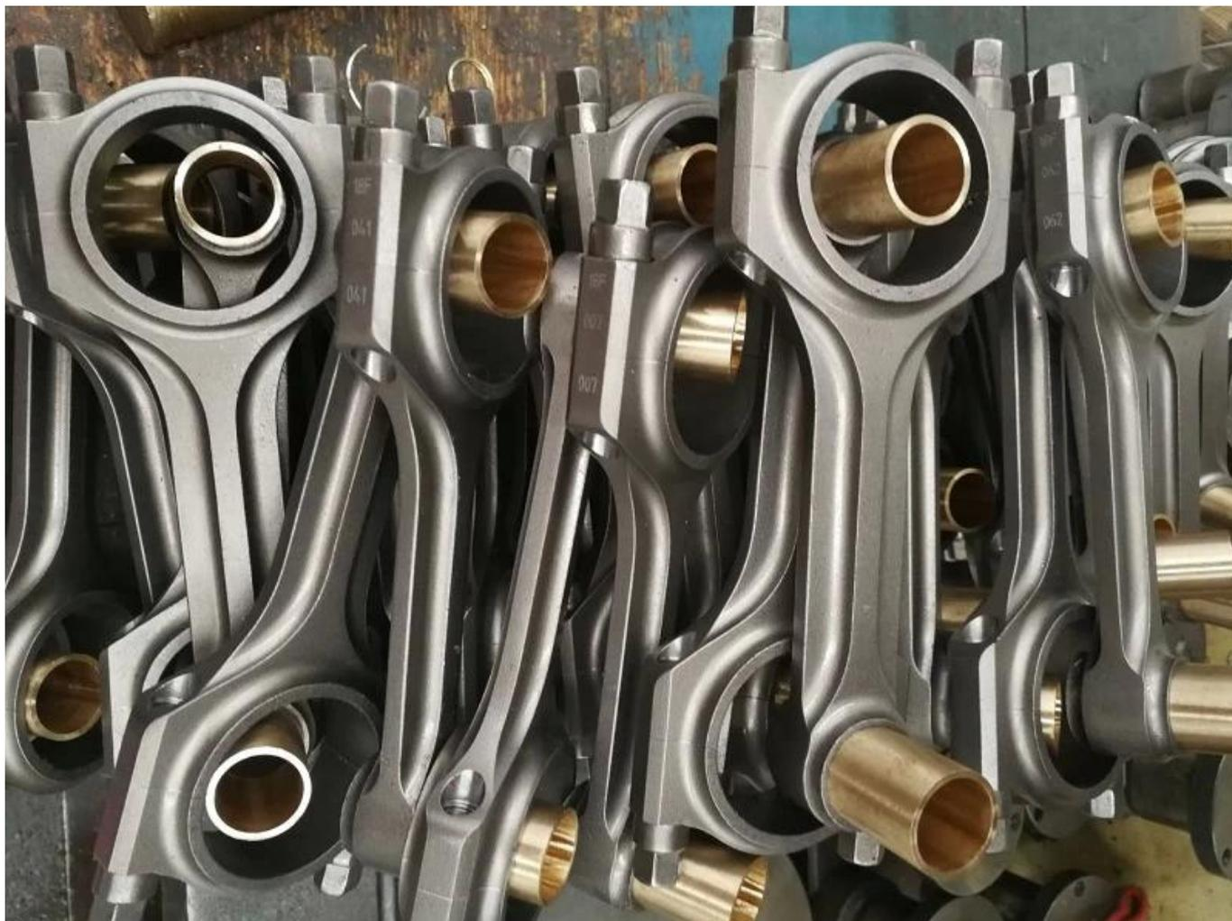
L'uragano Volvo 850 T5 C70 V70 2.3L 4340 Le bielle in acciaio forgiato con travi a X da 139,5 mm sono pronte per l'installazione di boccole.
