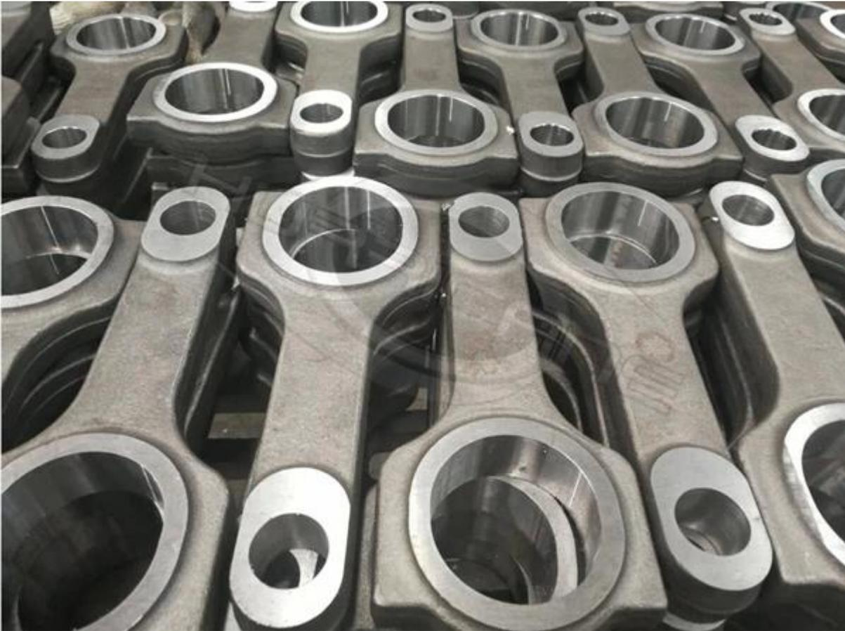
2). Progettato con **Forma a I-beam** per l'affidabilità ottimale nel settore delle corse
