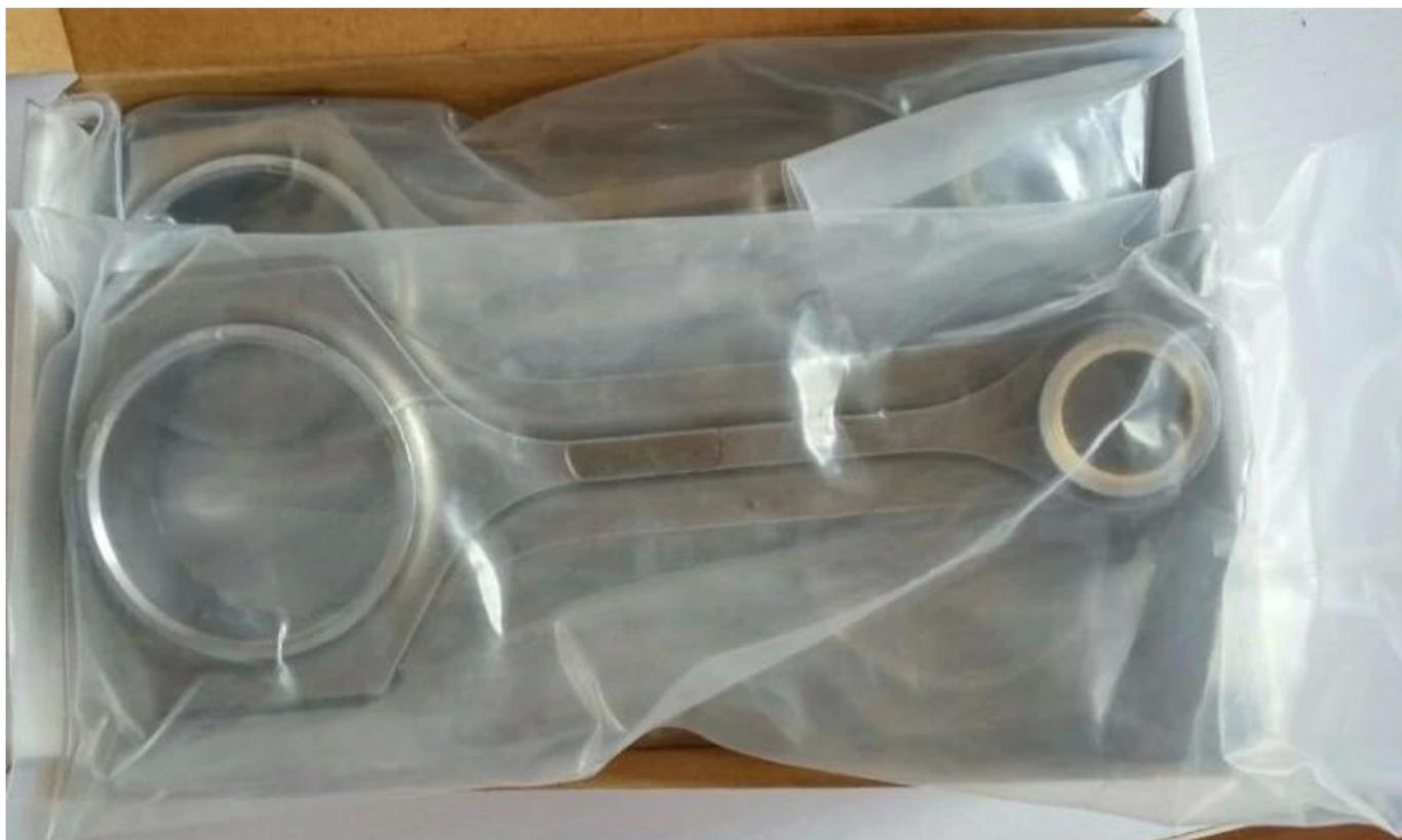
Le bielle forgiate per Toyota Lexus Yaris Echo Vios Scion XB 1NZFE 1.5L sono realizzate in acciaio molibdeno forgiato 4340, trattato termicamente per aumentare la resistenza alla trazione e pallettate per aumentare la durata della fatica. Le bielle Toyota 1.5L VVT-I 1NZ 1NZ-FXE 1NZ-FE hanno una boccola in bronzo resistente all'usura per una lunga durata e funzionalità del perno del polso [Elementi di fissaggio Hurricane 3/8](#).
