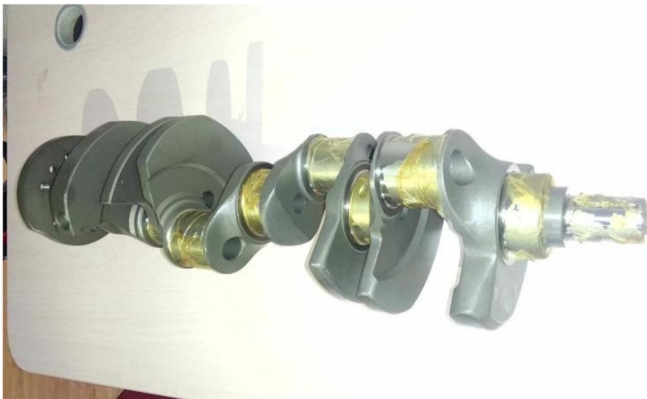
Le pedivelle forgiate a piccolo blocco Chevy 350 sul fianco e il profilo sono state lavorate e pallinate, aumentando efficacemente l'intensità
