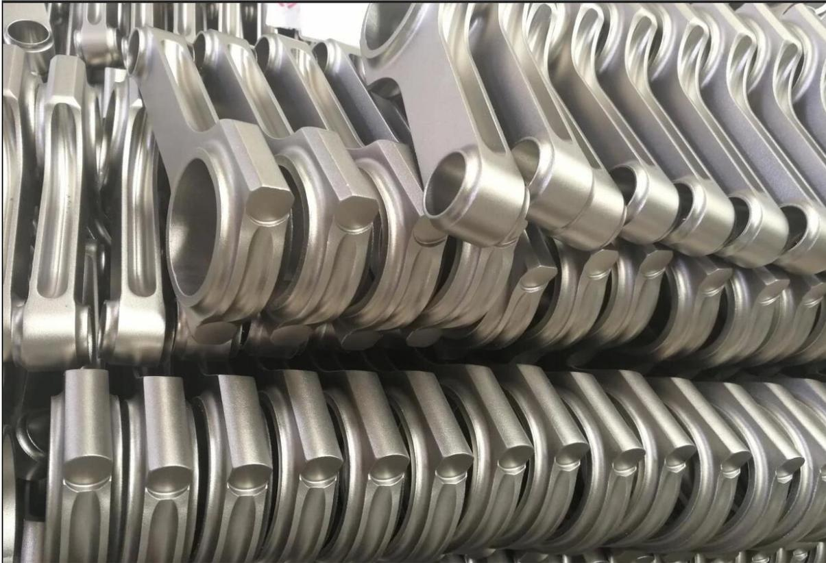
Infine, imballare con una tolleranza di peso inferiore a +/- 1 g in un set, di cui 8 pezzi per set.
