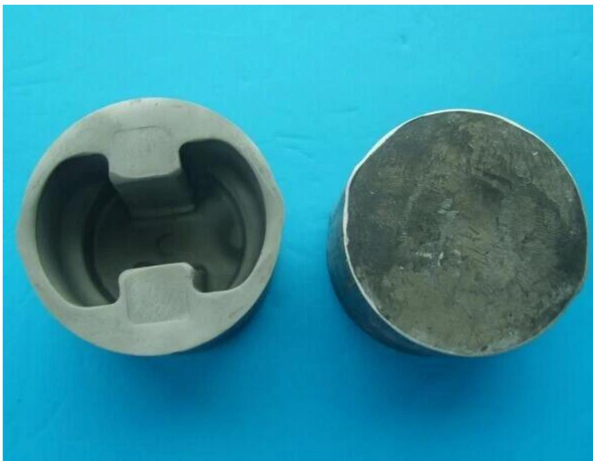
Sebbene il lato interno del pistone sia la superficie di forgiatura che non finisce la lavorazione, lo rendiamo ancora molto liscio.
