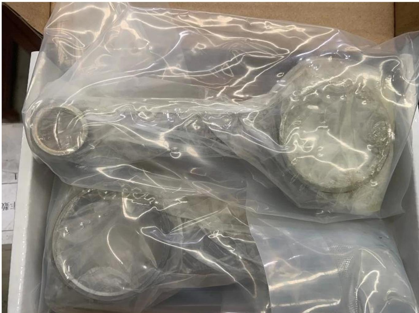
Le nostre bielle volvo 139.5mm sono pensate per sostituire le attuali bielle di fabbrica, questa modifica ti consentirà di eseguire livelli di spinta più elevati senza il timore di piegare una barra di fabbrica. Bielle H Beam - Il cilindro Volvo B5 5 da 139,5 mm suggerisce una potenza di 750 CV.
