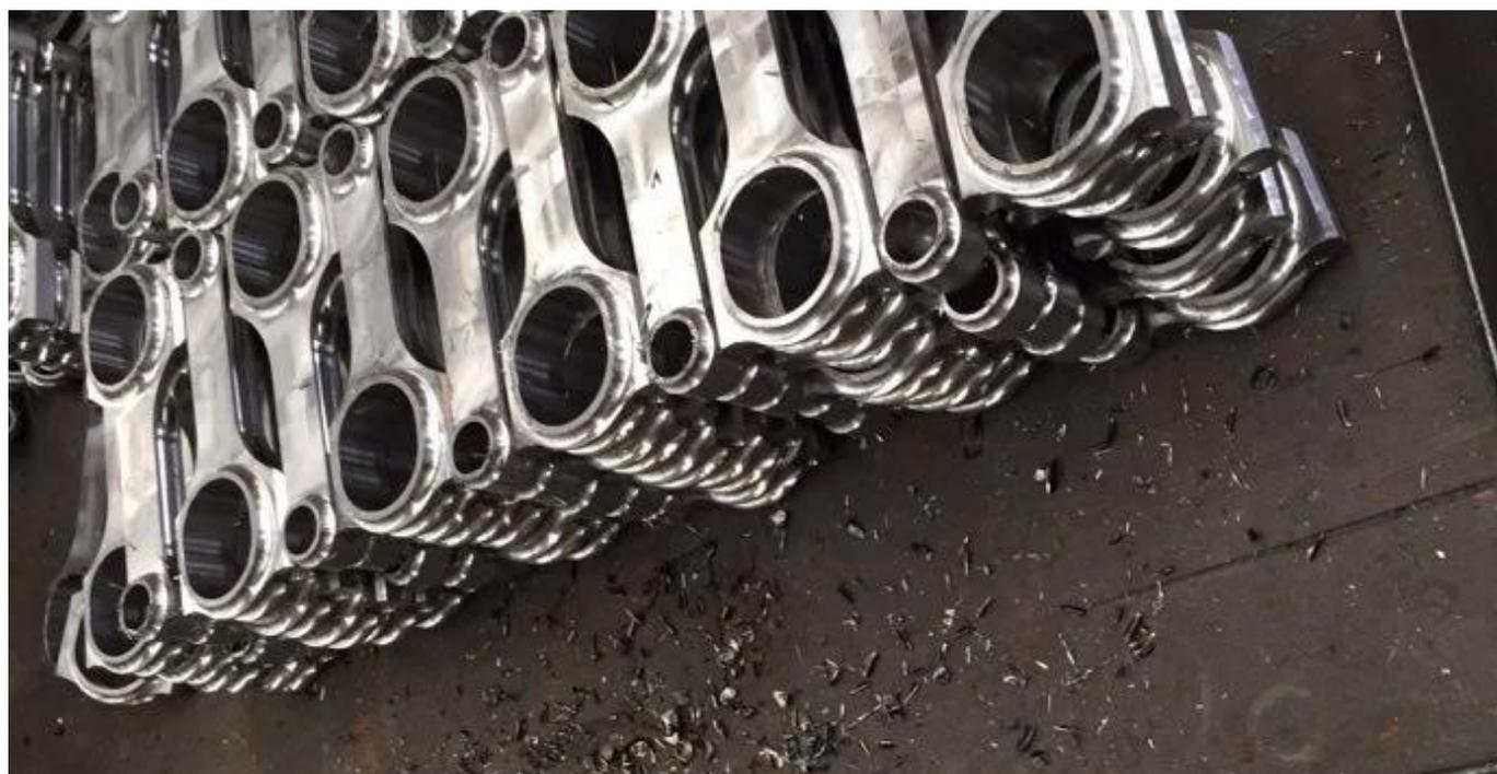
4 pz Bielle per Toyota Corolla Vios Belta Yaris Echo 1NZFE 1NZ-FE motore sono tutti lavorati a CNC, seguiamo una procedura rigorosa per ogni progresso per garantire un elevato livello di qualità. Per controllare la maggior parte della biella d'acciaio forgiata fabbricata in fabbrica 4343 per il toyota di hurricane, per favore, scatti prego il nostro [catalogo bielle di bielle](#) per informazioni più dettagliate.
