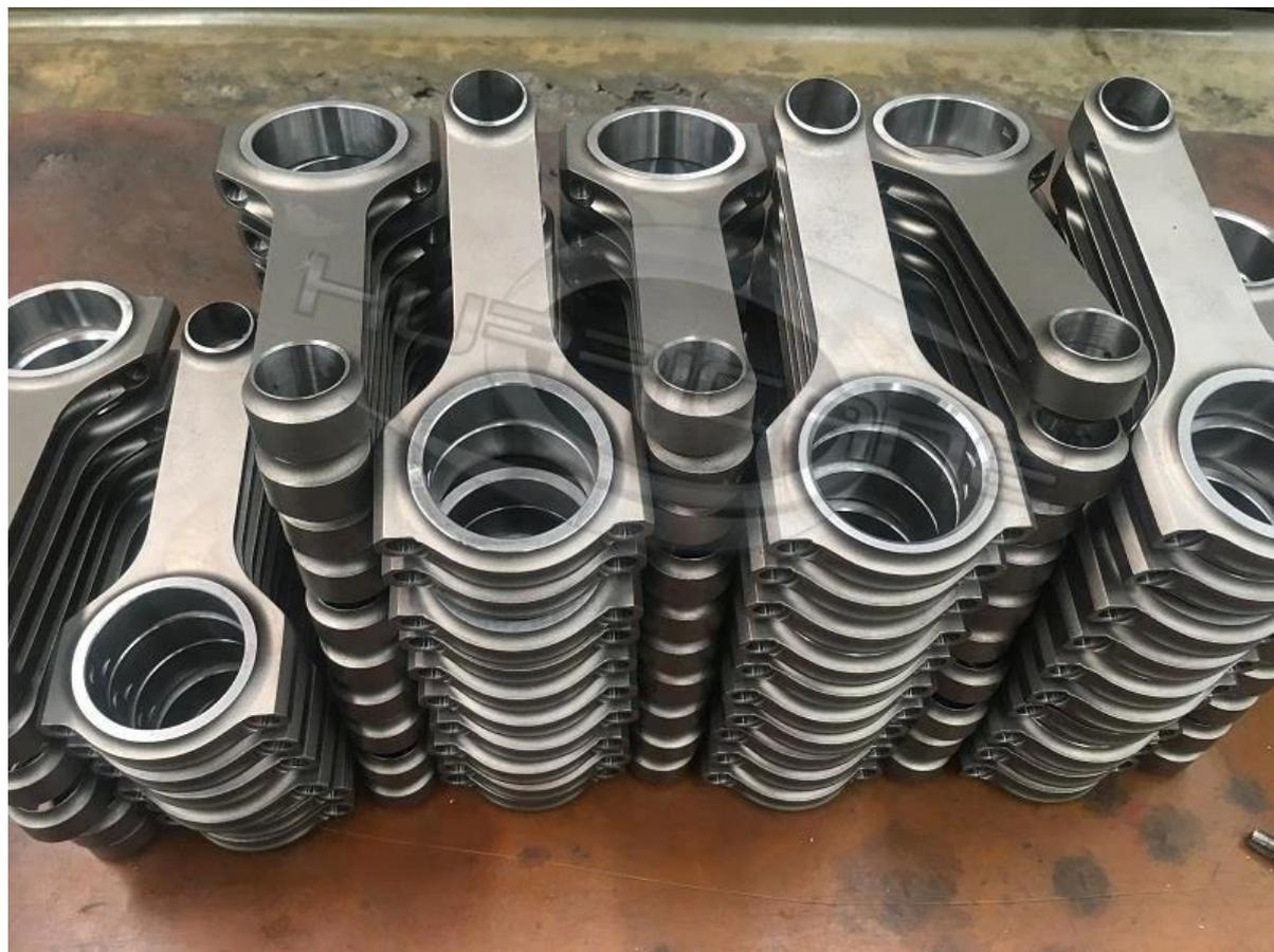
Tutta la boccola di bronzo di alta qualità installata per fornire resistenza all'usura per i pistoni galleggianti.
