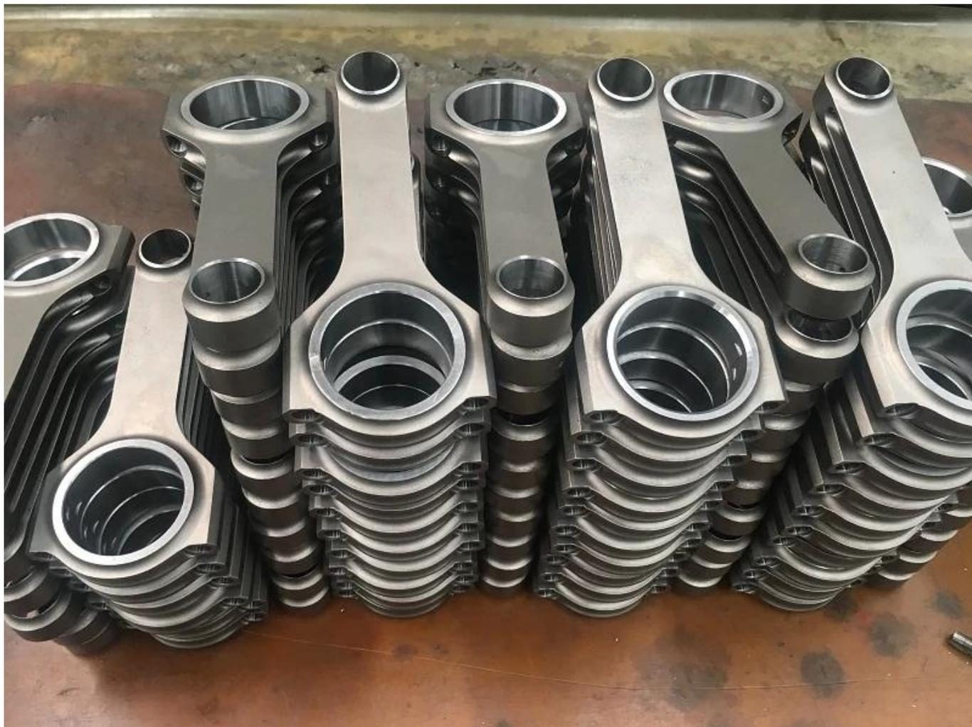
Hurricane ha anche prodotto il design I beam per l'applicazione Nissan QR turbo, la biella I beam è estremamente leggera del bean H e progettata per tutte le applicazioni NA e low boost.
