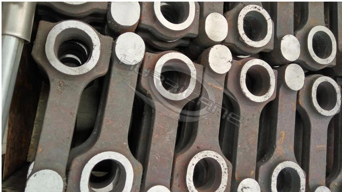
3. **Completamente lucidato e pallinato** per una maggiore durata a fatica per gestire lo stress extra dei motori ad alta combustione.
