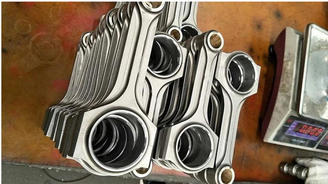
Le aste di collegamento Set NISSAN 350Z INFINITI G35 3.5L V6 VQ35DE sono per l'uso in applicazioni che richiedono un collegamento rafforzato tra albero motore e pistone. Le aste di collegamento X fascio per NISSAN VQ35DE 350Z G35 VQ35 sono di gran lunga superiori a qualsiasi asta prodotta OEM e può contenere 1000 potenza.
