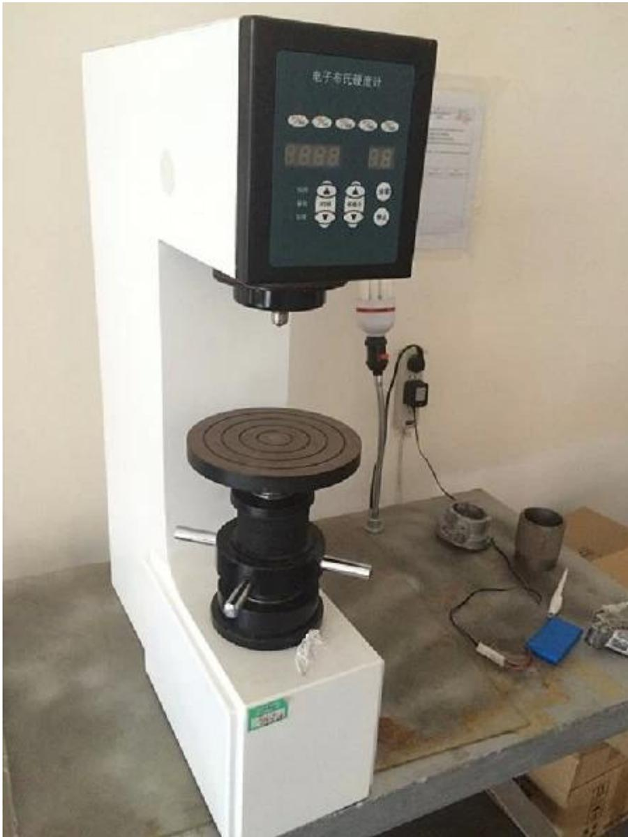
Nota: questa è la nostra macchina di prova di durezza, uragano bielle durezza 34-38 HRC.
