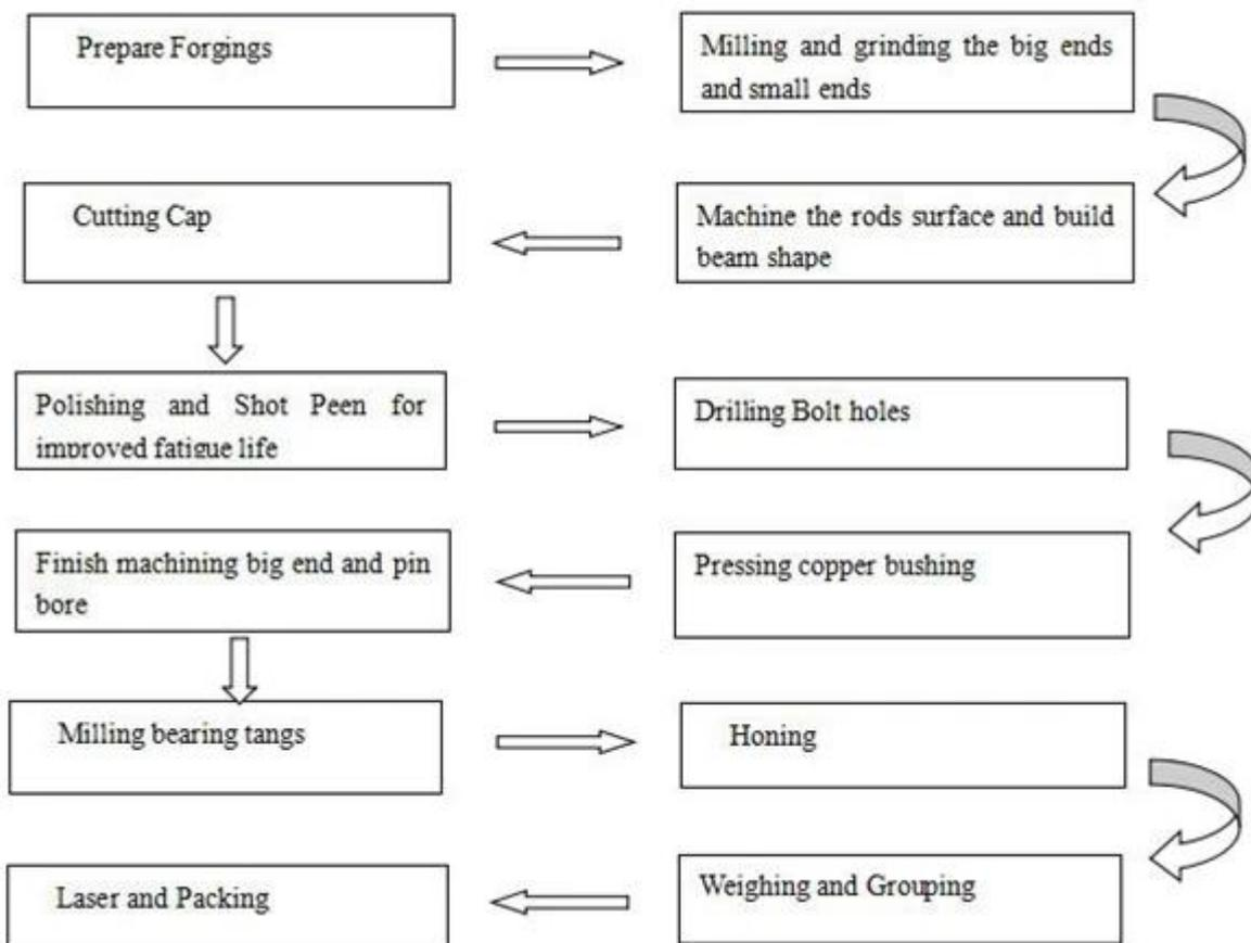
L'uragano può produrre bielle in base al campione usato e alle specifiche dettagliate, se OEM OEM il tuo stile di bielle, ecco alcuni passaggi per il tuo riferimento come di seguito:
