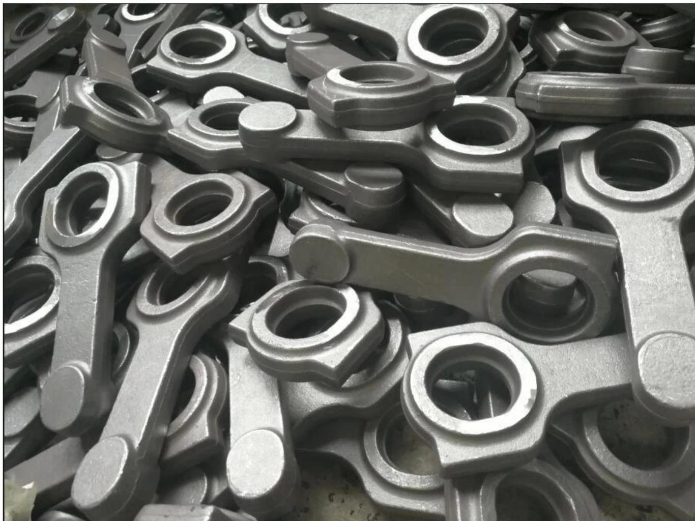
Il processo di forgiatura forza il grano nella forma di una biella, garantendo una durata a fatica superiore. Il
