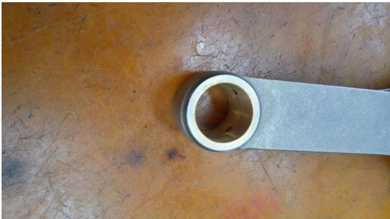
Nota: bielle Toyota 2jzgte h beam Foro dell'olio all'estremità del perno che fornisce lubrificazione.
