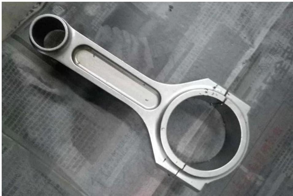
**Nota: questo è un passaggio per separare la trave dal suo cappuccio. Per ulteriori informazioni sui progressi, controllare: [Bielle Hurricane High Performance - Processo di lavorazione delle aste](#)**
