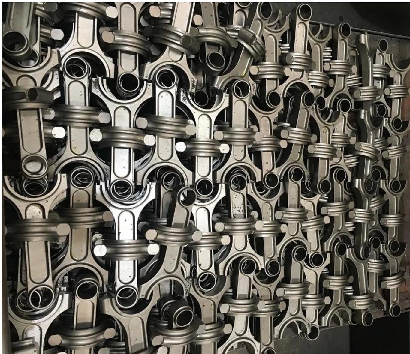
Nota: le bielle Toyota Celica, MR2 Turbo 2.0L 3SGTE 3S-GTE saranno lucidate (rimuovono le sbavature e rendono la superficie liscia) e pallettate per prime, quindi separano le bielle dal cappuccio.
