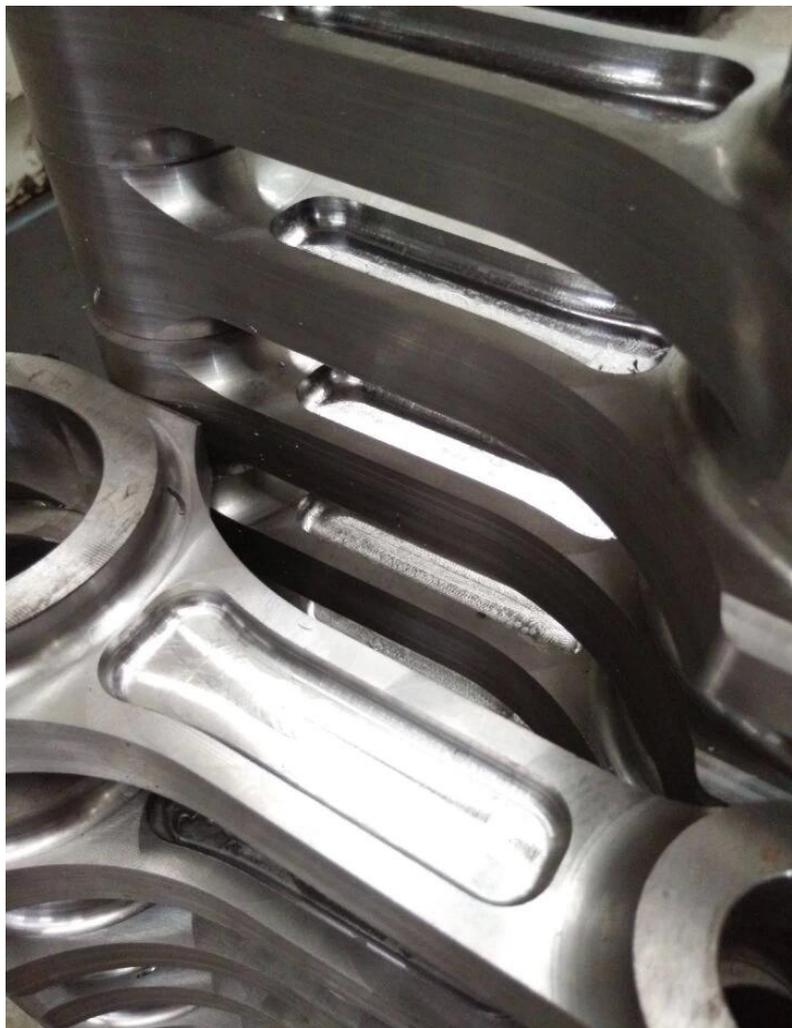
Le robuste bielle diesel affusolate duramax sono in grado di gestire carichi estremi del motore. La trave affusolata consente un certo risparmio di peso sull'estremità di reciprocazione e offre maggiore spazio per i pistoni completamente scatolati.
