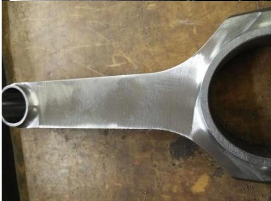
Nota: barre di collegamento uragano prima delle lucidate. Nota: barre di collegamento dell'uragano dopo levigate Hurricane ha anche HAD Design per HONDA H22 Conrods, clicca qui [Set di aste di collegamento HONDA PRELUDE H22 FORGE H22, foro per pin da 22 mm](#)
