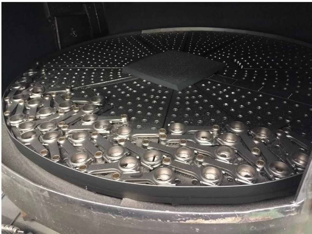
Nota: in qualità di produttore di canne di qualità nelle industrie da corsa, tutte le bielle Hurricane sono pallinate in fabbrica con palline d'acciaio per migliorare la durata della fatica per migliorare la resistenza e anche per rendere le canne più belle e lisce.
