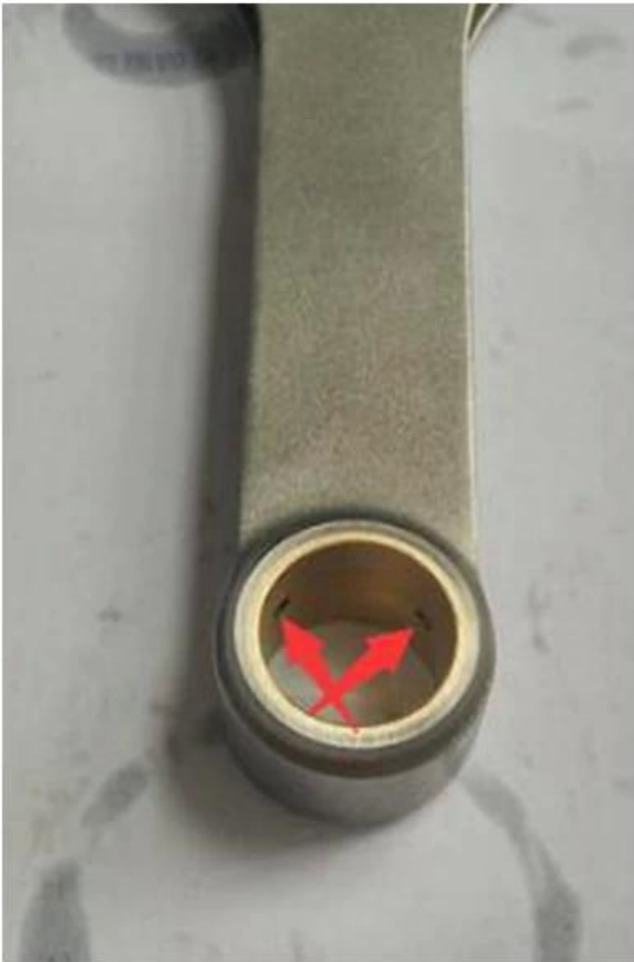
Due piccoli fori per l'olio praticati nella piccola trave di estremità tagliata per una buona lubrificazione.
