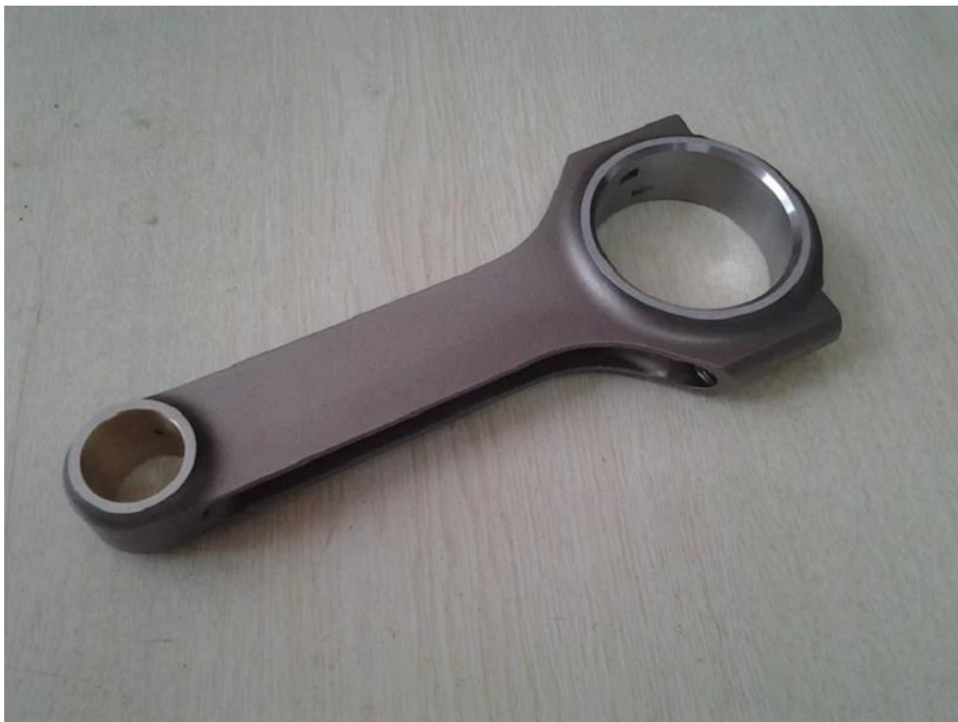
Bielle GM Chevy SBC Pro Sport H-Beam, lunghezza 5.850, perno da polso con attacco a bussola 0,927, foro da 2.225 estremità grande, bulloni per asta uragano 7/16, peso pubblicizzato 550 grammi, set da 8
